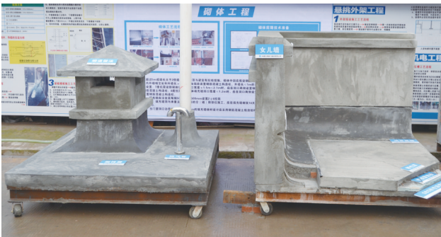
屋面烟道及防水施工顺序优化可移动样板模块展示图
