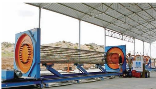
近日,中建股份京新高速公路总包项目部引进了一台GLJ2000型数控钢筋笼成型机。该机是内蒙古地区引进的首台数控钢筋笼成型机,与人工相比提高工效6倍。(吴胜祥)
