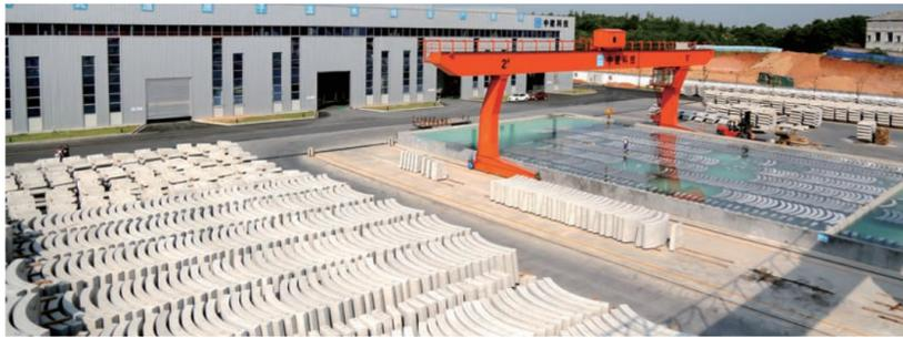
公司目前每天可生产40环隧道管片,用于长沙地铁4号线地铁建设。图左为摆放整齐即将发往施工现场的成品管片;右为水养池,从车间倒模出来的管片需在清水池中先行浸泡养护。
