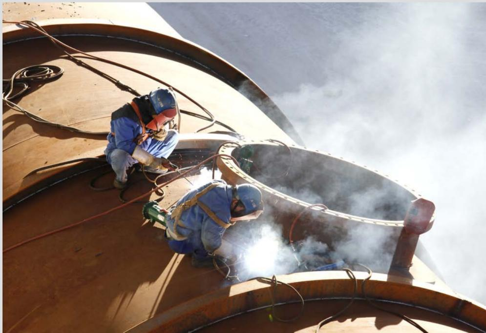
近日,中建安装化工设备公司正加紧制造出口印度的煅烧炉。该煅烧炉不仅严格按照美国ASME标准设计,还需通过印度IBR机构认定合格。参与该设备加工的焊接工人也必须持ASME焊工证上岗,从高级焊工到取得ASME焊工证,需要通过最短3个月的培训与考核。
