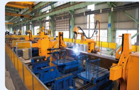
总成焊接机器人工作站
