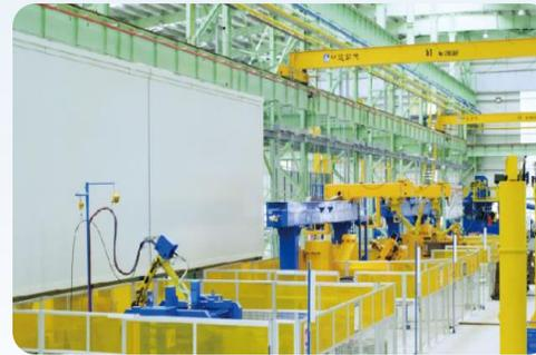
部件焊接机器人工作站
