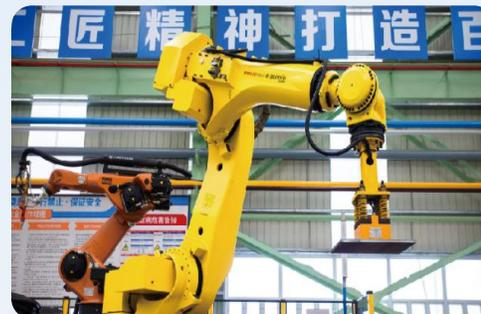
搬运机器人、坡口机器人工作站
