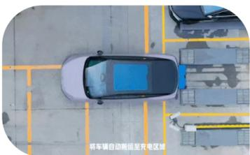
AGV机器人稳稳托起车辆，送入充电区域
