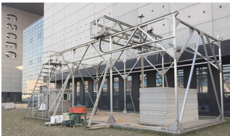
近日,中国建筑技术中心“建筑3D打印材料及应用技术”科技成果通过了由中建总公司组织的专家组鉴定,总体达到国际先进水平。该成果研制的建筑3D打印用水泥基材料,具有良好的触变性、粘结性,抗压强度达60MPa。图为3D打印机和其打印的实体构件。(李艳梅)
